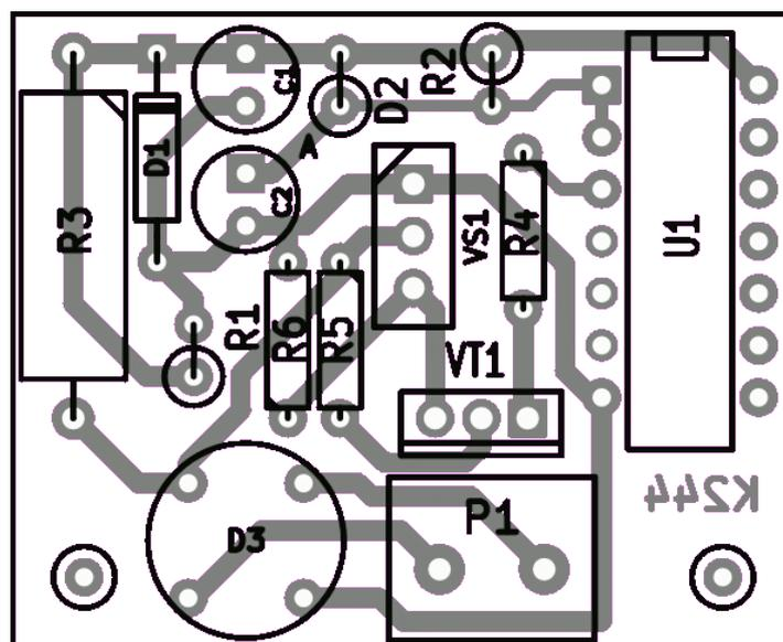
**Внимание:** устройство гальванически не развязано от сети! Запрещается прикасаться к элементам включенной схемы!
