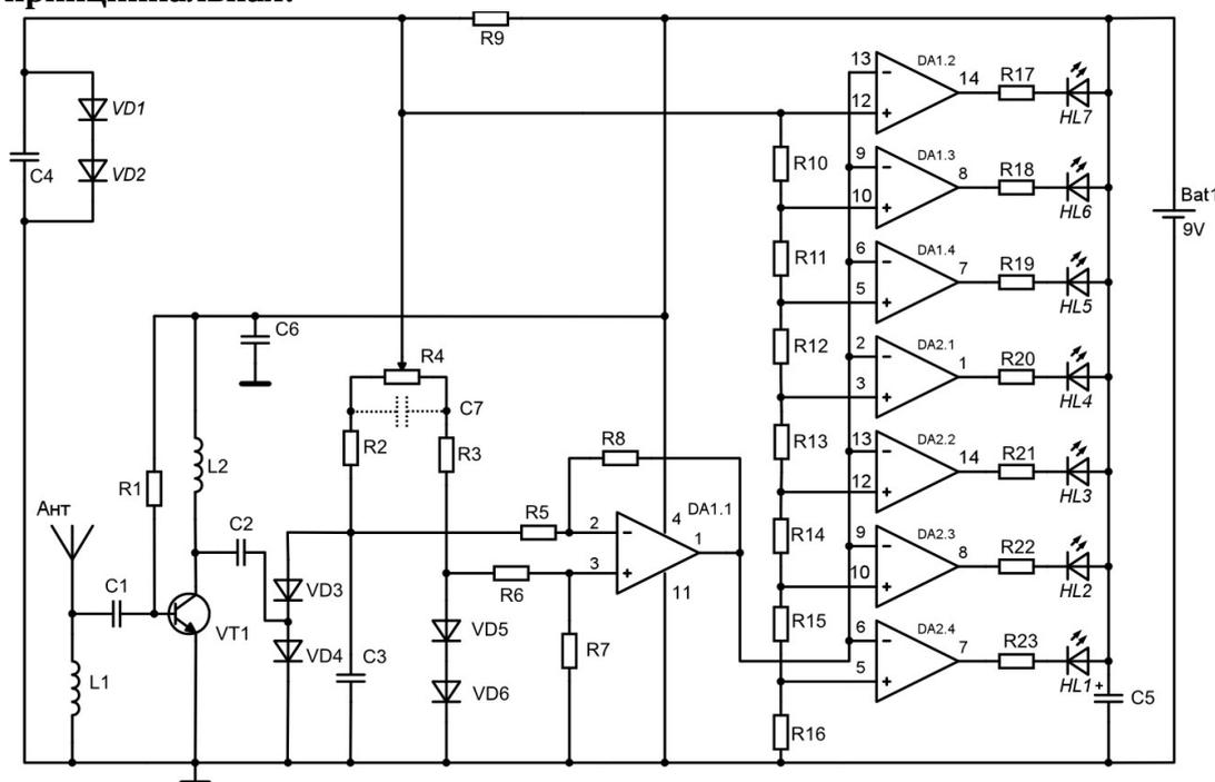
Сигнал, усиленный УВЧ на транзисторе VT1, поступает на балансный детектор, собранный на диодах VD3-VD6, равновесие которого регулируется резистором R4. Продетектированный сигнал поступает на дифференциальный усилитель DA1.1. На ОУ DA1.2-DA2.4 собраны компараторы напряжения, к которым подключены светодиоды HL1-HL7. Резисторами R10 - R16 задаются опорные напряжения компараторов.
